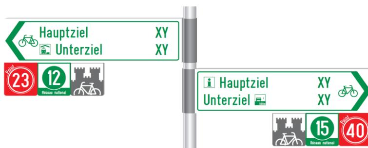
Abbildung 69: Hauptwegweiser mit Einschubplaketten
