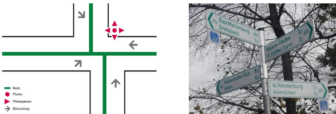
Abbildung 37: Pfeilwegweiser an Kreuzungen mit vier Richtungen
