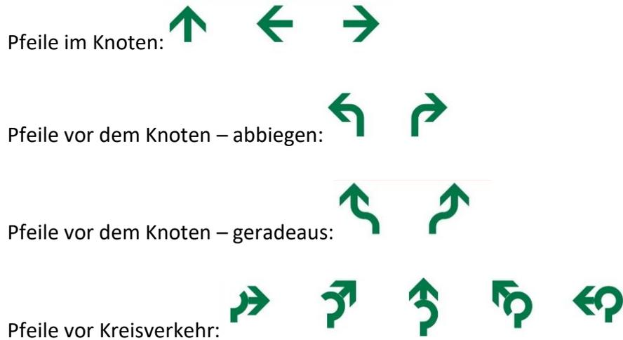
Abbildung 45: Verwendbare Pfeilrichtungen
