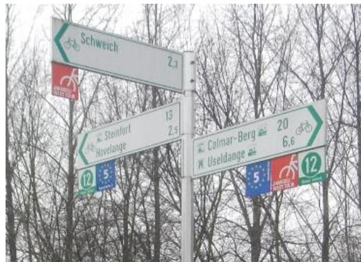
Abbildung 78: Gestufte Montage und 90-Grad-Wegweiser ganz oben wegen Einhalten des Lichtraumprofils
