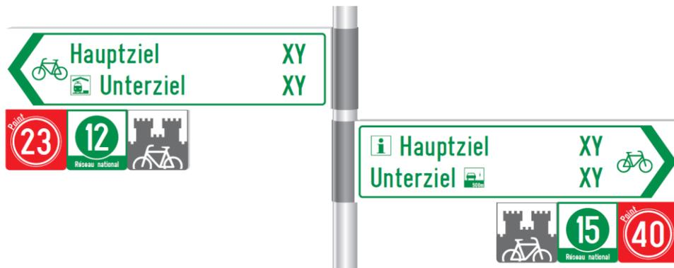
Abbildung 32: Pfeilwegweiser mit Einschubplaketten
