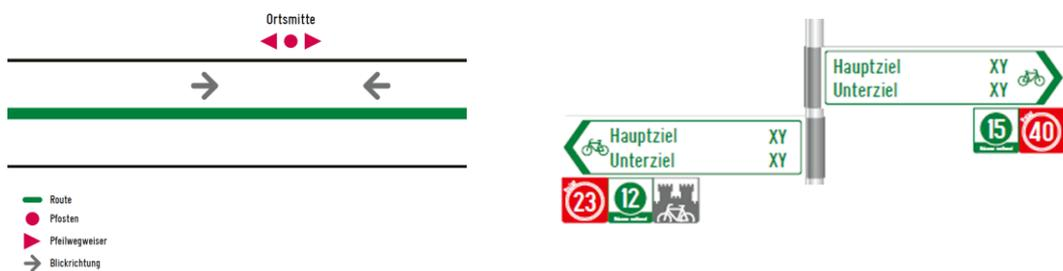
Abbildung 39: Pfeilwegweiser an Standort mit zwei Richtungen
